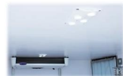
Світлодіодний світильник з перемикачем всередині кабіни
