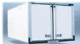
Композитні панелі (харчовий гелеобразний шар - поліефір - поліуретан), оснащені алюмінієвими вставками
